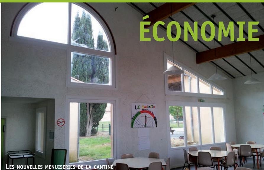
Continuant à rechercher les économies possibles, la mairie vient de terminer l'isolation de l'école élémentaire ainsi que le remplacement des menuiseries. La cuisine et la cantine ont également été équipées de portes et fenêtres neuves à double vitrage, ces bâtiments, sont maintenant parfaitement isolés. La chaudière a été remplacée l'année dernière par une « chaudière à condensation » et le contrat de gaz renégocié dernièrement avec un nouveau fournisseur à un prix bien inférieur.
